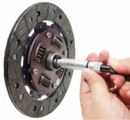
Instale el disco de embrague con la placa de presión del embrague. Apretar ligeramente los tornillos de fijación del plato de presión del embrague. El disco de embrague debe poder moverse radialmente.
