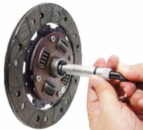
Installer le disque d'embrayage avec le plateau de pression d'embrayage. Serrez légèrement les boulons de fixation du plateau de pression d'embrayage. Le disque d'embrayage doit pouvoir se déplacer radialement.
