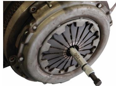
Presione la herramienta de alineación del embrague con el disco del embrague hacia el motor y apriete uniformemente los tornillos de fijación de la secuencia del plato de presión del embrague. Al final, apriete los tornillos al par especificado.
