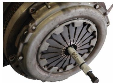
Appuyez l'outil d'alignement d'embrayage avec le disque d'embrayage vers le moteur et serrez uniformément les vis de fixation de la succession du plateau de pression d'embrayage. Serrez les vis à la fin avec le couple spécifié.
