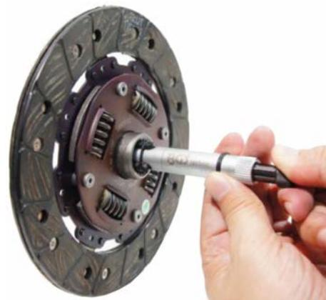
Kupplungsscheibe mit Kupplungsautomaten montieren.
