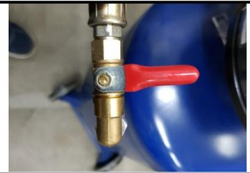
Das Absperrventil an der Unterseite des Messzylinders verschließen.
