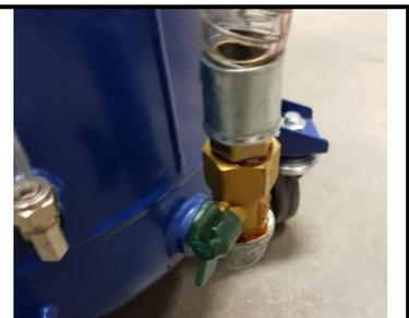
Fermez la vanne d'arrêt sur le tuyau d'aspiration (2)
