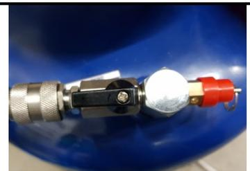
Abra lentamente la válvula de cierre en la parte inferior del depósito, asegurándose de que el codo de la tubería de la manguera de drenaje permanezca en el depósito de aceite residual.
