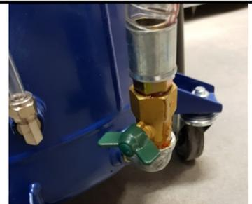
Insérez le coude à l'extrémité du tuyau de vidange dans un réservoir d'huile usagée.
