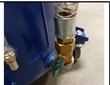
Absperrventil am Saugschlauch (2) verschließen
