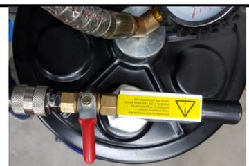
Absperrventil am Saugschlauch (2) verschließen.
