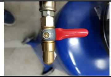
Druckluftquelle mit dem Druckluftanschluss (3) verbinden und Ventil öffnen.
