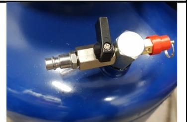
Absperrventil unten am Messzylinder verschließen.
