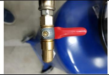
Cierre la válvula de cierre en la parte inferior del cilindro de medición.
