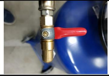
Conecte la fuente de aire comprimido a la conexión de aire comprimido (3) y abra la válvula.
