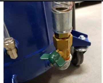
Inserte el codo de la tubería en el extremo de la manguera de drenaje
