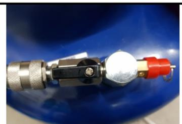
Ouvrez lentement la vanne d'arrêt sur le fond du réservoir, en vous assurant que le coude du tuyau de vidange reste dans le réservoir d'huile usagée.
