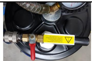
Fermez la vanne d'arrêt sur le tuyau d'aspiration (2).
