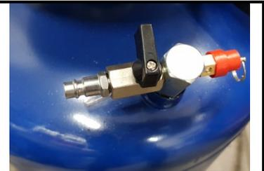
Cierre la válvula de cierre en la parte inferior del cilindro de medición.
