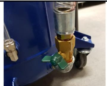
Rohrbogen am Ende des Ablaufschlauchs in einen Altöltank einführen.
