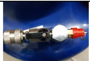
Das Absperrventil am Behälterboden langsam öffnen, dabei darauf achten, dass der Rohrbogen des Ablaufschlauchs im Altöltank verbleibt.
