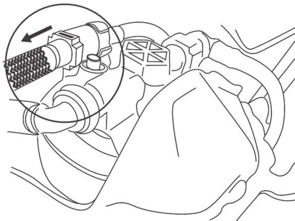
2. Den passenden Anschluss auswählen und mit dem System verbinden.
