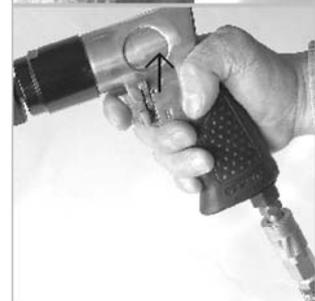
6. Stellen Sie das F/R Ventil nach unten auf die Position "R" (Abb.5) und betätigen Sie den Auslöser. Die Maschine beginnt zu Arbeiten (linksdrehend). Wenn notwendig, können Sie in dieser Stellung den Bohrer im Werkstück Freidrehen.
