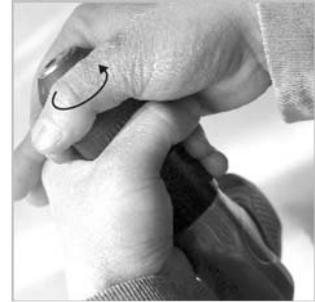
3. Stecken Sie den Bohrer in das Bohrfutter und Befestigen Sie diesen durch Drehen des Bohrfutters von Hand im Uhrzeigersinn. Stellen Sie sicher, dass der Bohrer mittig und feste im Bohrfutter sitzt, bevor Sie die Bohrmaschine verwenden (Abb.2) **ACHTUNG:** Verwenden Sie nur Bohrer deren Drehzahlfestigkeit gleich oder höher der Bohrmaschinen-Drehzahl ist.
