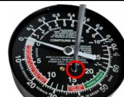
Nehmen Sie einen Schlitz-Schraubendreher und drehen Sie die Einstellschraube in die Richtung, in der der Zeiger nachjustiert werden muss. In dem gezeigten Beispiel muss die Einstellschraube im Uhrzeigersinn gedreht werden.
