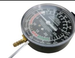
Prendere un cacciavite a fessura e girare la vite di regolazione nella direzione in cui il puntatore deve essere regolato. Nell'esempio mostrato, la vite di regolazione deve essere ruotata in senso orario.
