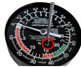
Con un destornillador plano, gire el tornillo de ajuste en la dirección en la que deseé reajustar la aguja. En el ejemplo mostrado, el tornillo de ajuste debe girarse en el sentido de las agujas del reloj.
