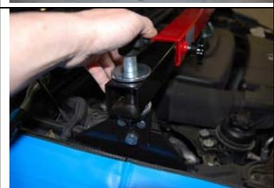
Sind die zwei Fixierschrauben für die Neigungsjustierung, die Hand-Fixierschrauben der Stützen und der Vierkantrohre festgezogen, wird nun die Kette an den entsprechenden Stellen des Motors und in der Haltespindel befestigt.
