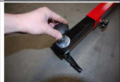
Stecken Sie die Haltespindel in die mittlere Bohrung des Mittelstücks und schrauben Sie die große Flügelmutter einige Umdrehungen auf die Haltespindel.
