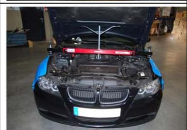
Setzen Sie die Motor-Traverse mit den Stützen auf die Kotflügelverschraubungs- bzw. Schweißkante. Stellen Sie sicher, dass beide Arretierschrauben der verschiebbaren Vierkantrohre nach dem Ausrichten befestigt sind.
