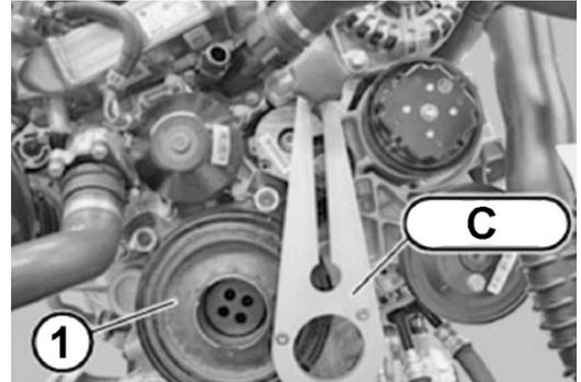
Die Bolzen (1) auf dem Schwingungsdämpfer (2) lösen. Spezialwerkzeug (C) im Bereich des Schwingungsdämpfers (1) ausbauen. Den Schwingungsdämpfer ausbauen.
