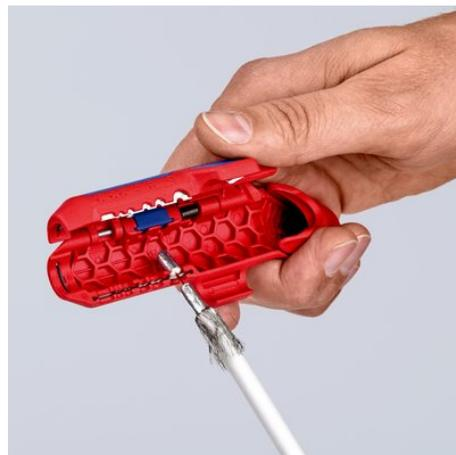
Abisolieren eines Koaxialkabels
