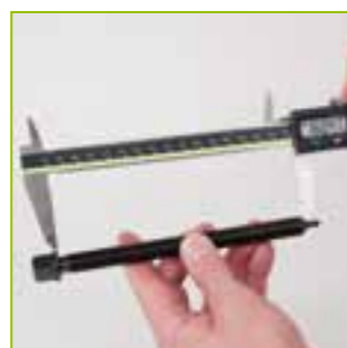
b Messen Sie die Gewindelänge bis zur Spindelspitze.
