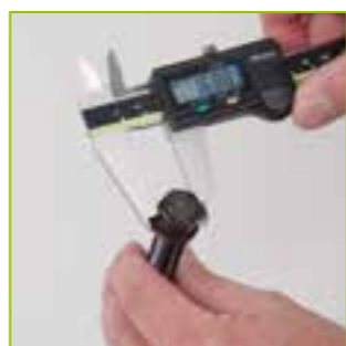
d Messen Sie den Sechskant des Spindelkopfes.
