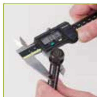
a Messen Sie den Spindeldurchmesser.
