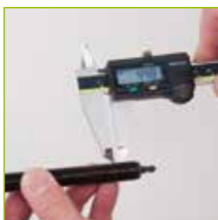
c Messen Sie die Länge über 3 Gewindegänge.
